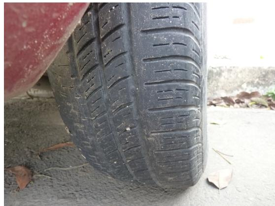
Las llantas delanteras y traseras se encuentran en mal estado por desgaste y cuenta con llanta de repuesto. Los tapizados son en cuero sintético están en mal estado con presencia de rasgaduras.
