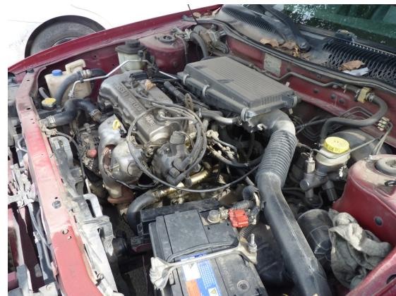
Las unidades de luces delanteras están en buen estado y el stop derecho tiene fisura. El motor es gasolina de 1.600 cc, presenta fugas por empaquetaduras. En la dirección hidráulica y caja mecánica no se observan fugas. Su estado electromecánico es aceptable y requiere un mantenimiento general.
